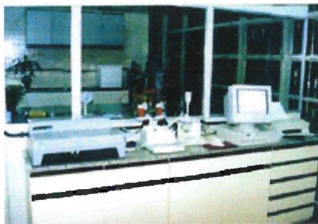
Figura 22: Zetasizer 3000 produzido pela Malvern Instruments, no Laboratório de Físico-Química de Interfaces
